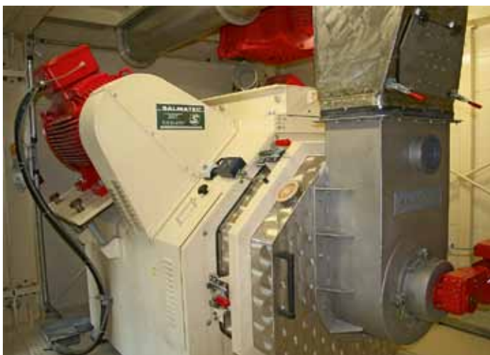
Die Pelletierpresse von Salmatec ist mit einer Leistung von 4 t/h das Herzstück der Anlage
