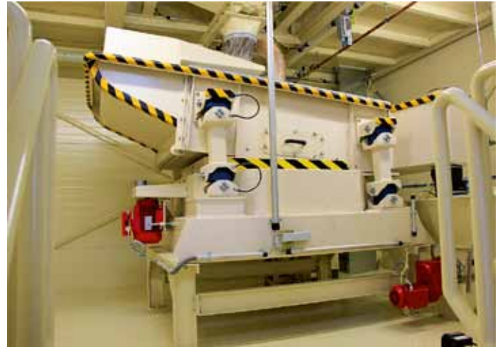
In der Siebmaschine von Teccon werden die Pellets zur Sicherstellung eines niedrigen Staubgehaltes gesiebt, der Feinanteil wird wieder verwendet
