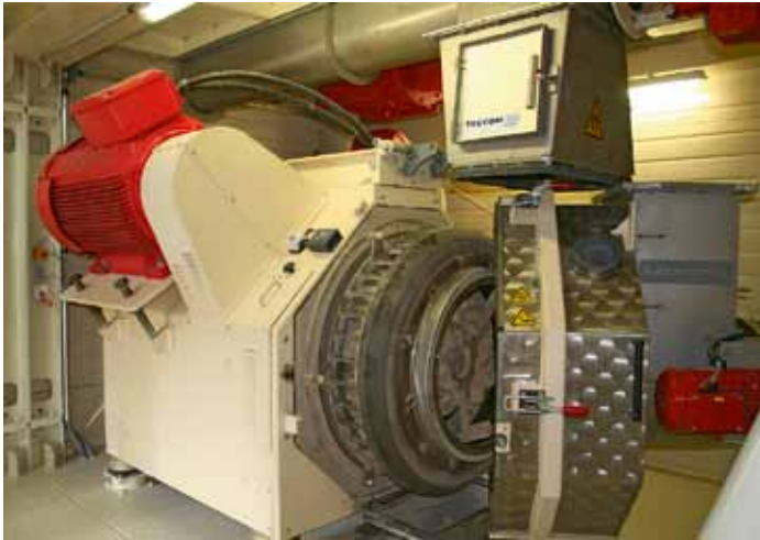
Die Salmatec-Press hat eine Leistung von 5 t/h und wird von zwei Motoren mit je 160 kW angetrieben
